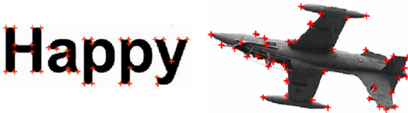
图 5.1.5 用 SUSAN 算子检测到的角点
