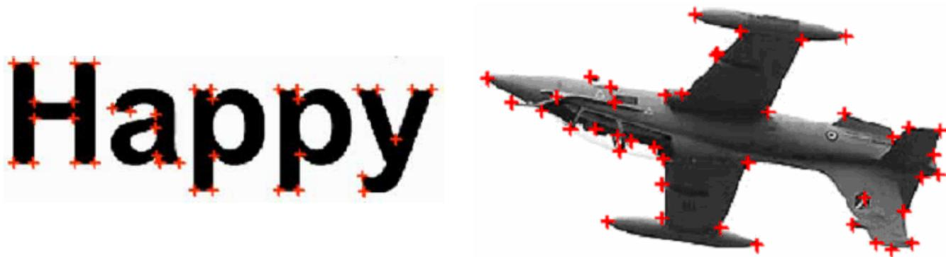
图 5.1.5 用 SUSAN 算子检测到的角点
