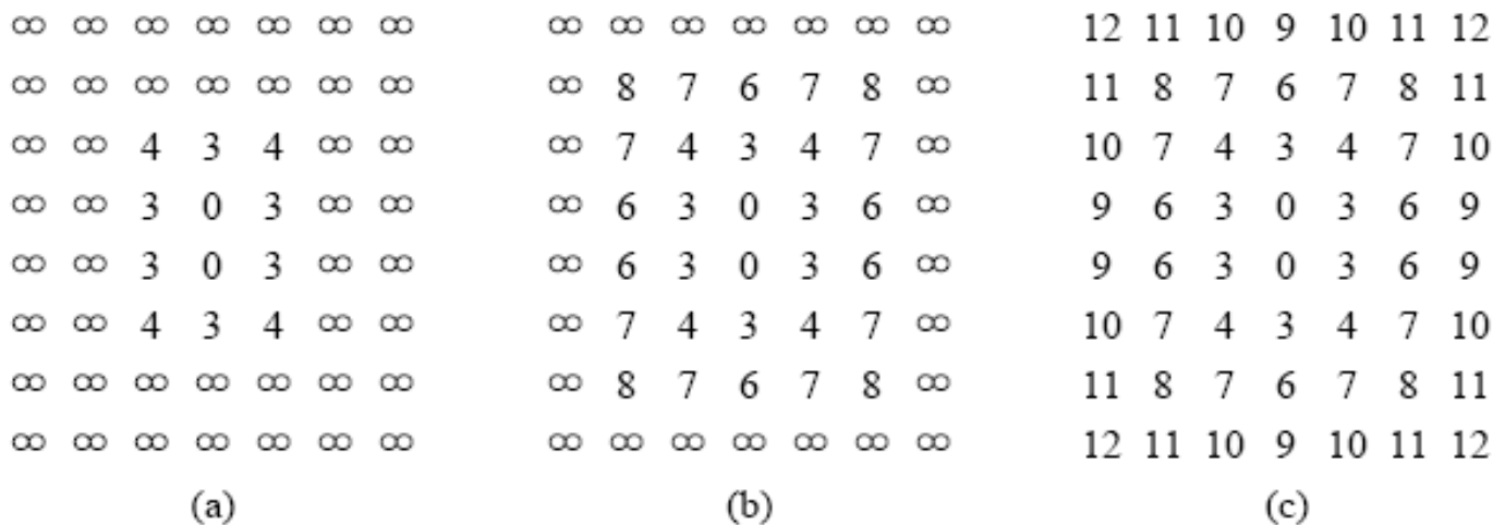
图 3.4.6 并行计算过程中的各个步骤所得到的距离图
